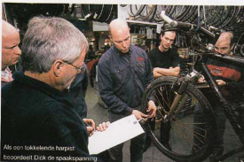
Deze spaakleutel houdt de spaak vast op vier punten, drie van de vier zijden van de rippel en de spaak, heel in opgroef
